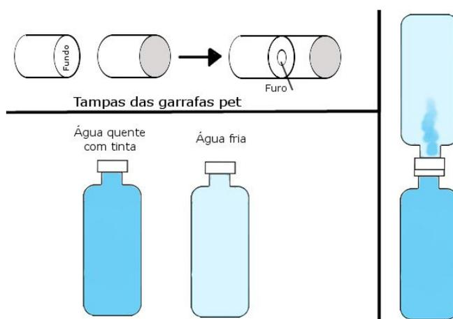
Figura 2 – imagem da montagem do experimento prático
